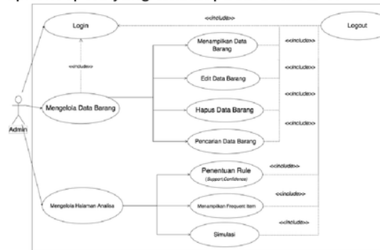
Gambar 2 Use Case Diagram Sistem Rekomendasi Barang
