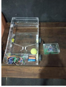
Gambar 13. Prototype produk robot pemungut bola dan remot
